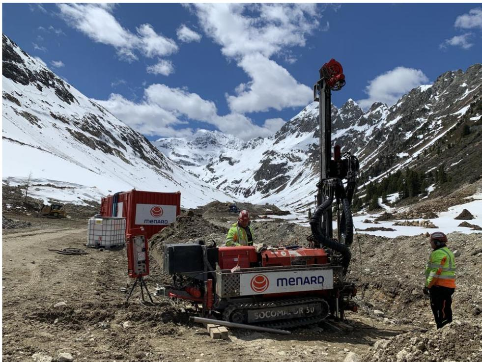
**Abbildung 8: Durchführung der Pressiometerversuche im Kühltai-Gebirge**
